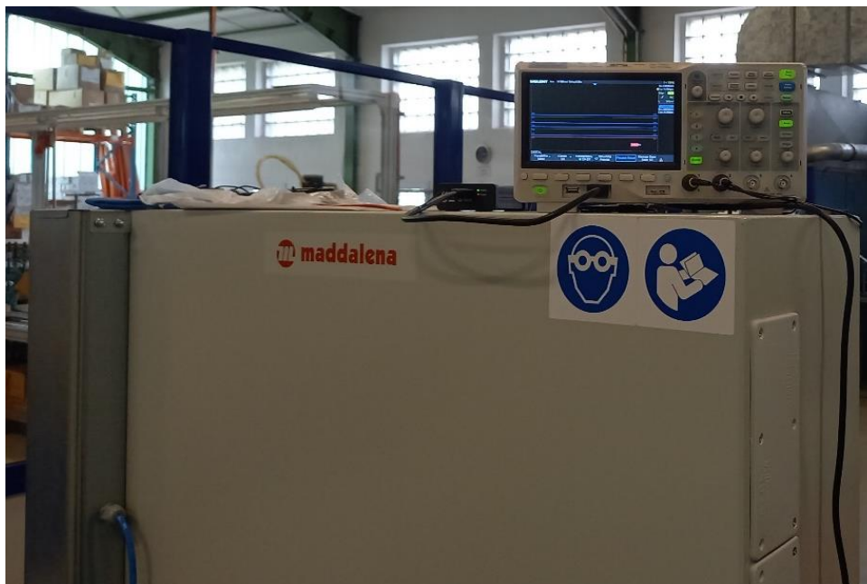
Logik-Analysator am Prüfstand zur Validierung der Signalqualität
