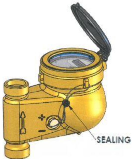
Abb. 4: Gehäuse der senkrechten Ausführung und Verplombung Zähler DS TRP
