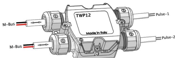
Contaimpuls per applicazioni metering in configurazione slave su linea M-Bus in grado di acquisire fino a 2 ingressi impulsi (reed switch, contatti puliti – open collector).
