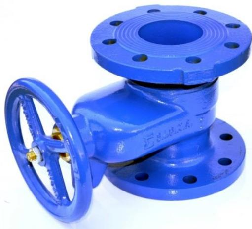
**Robinet-vanne de sectionnement** qui combine les caractéristiques des robinets-vannes à celles des vannes classiques. Il associe une faible perte de charge, un passage libre, une fermeture et une ouverture progressives à modulation continue et l'étanchéité aux fluides abrasifs, calcaires ou avec solides en suspension.
