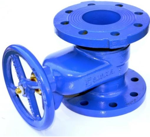
Esta **compuerta de protección** combina las características de las compuertas con las de las válvulas. Combina baja pérdida de carga, paso libre, cierre y apertura graduales con modulación continua y estanqueidad con líquidos abrasivos, depósitos calcáreos o con partes en suspensión.
