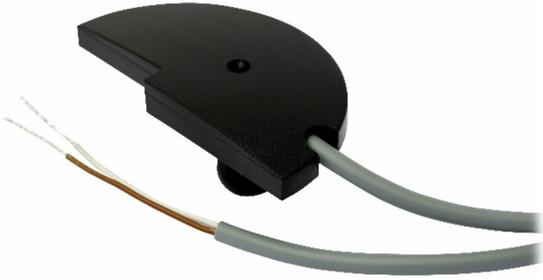
La rotation de l'aiguille des litres est détectée par un capteur optique intégré de la dernière génération qui reconnaît le sens du flux. En effet, en cas de reflux, le volume est totalisé en interne et une fois que le flux normal est rétabli, aucune impulsion n'est générée jusqu'à la récupération du volume précédemment totalisé.
