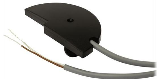
La rotazione della lancetta dei litri è rilevata da un sensore ottico integrato di ultima generazione che discrimina la direzione del flusso dell'acqua. Infatti, in caso di reflusso, il volume verrà totalizzato internamente e, una volta ripristinato il normale flusso, non verranno generati impulsi fino al recupero del volume precedentemente totalizzato.
