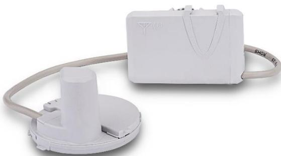
Kontaktloses M-Bus Funkmodul mit bidirektionalem induktivem Sensor für die Halbtrockenläufer-Mehrstrahl-zähler Serie DS TRP. Compact Version als direkter Aufsatz und Split Version zur Montage des Funkteils an die Wand.
