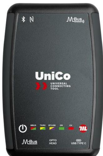
El nombre UniCo reúne los términos **Universal Connecting** (Conexión Universal) y es un dispositivo multifunción con múltiples características. Compacto, ligero, caracterizado por una máxima flexibilidad de uso y una buena autonomía, está diseñado para dos propósitos principales: recibir mensajes wM-Bus en modo T1/C1 en la banda ISM de 868 MHz y servir de interfaz para programar los dispositivos Maddalena.
