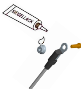
Fig. 13 Sigillatura del bullone con colla
