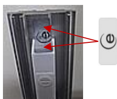
Fig. 27 Applicazione del sigillo adesivo alla piastra
