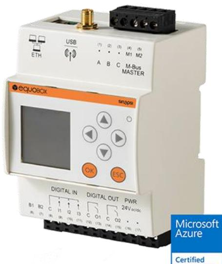
RTUEVO1T (1.ETRSEQ.0051) est un enregistreur de données pour l'acquisition de données provenant des 1.ETRSEQ.0012, qui, via le réseau MESH, collecte des informations de dispositifs qui utilisent le protocole M-Bus filaire et wireless tels que les compteurs, les répartiteurs de consommation et les sondes. Il gère jusqu'à 3000 compteurs (2500 wireless + 500 filaires) en permettant d'enregistrer les relevés quotidiens pendant 10 ans.
