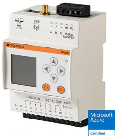
RTUEVO1T (1.ETRSEQ.0051) es un registrador de datos para la adquisición de datos de los 1.ETRSEQ.0012, que, a través de la red MESH, recogen información de los dispositivos que utilizan el protocolo M-Bus por cable e inalámbrico, como contadores, repartidores de consumo y sondas. Gestiona hasta 3000 contadores (2500 inalámbricos + 500 por cable) permitiendo almacenar las lecturas diarias durante 10 años.
