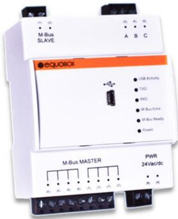
Le level convert M-Bus 1.ETRSEQ.0003 permet l'interfaçage avec un réseau de dispositifs compatibles avec le standard M-Bus (EN 13757-2 Couche physique) et supporte jusqu'à un maximum de 60 slaves.
