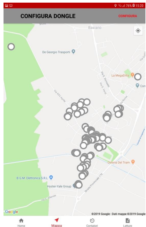
Pannello di navigazione con le posizioni dei contatori
